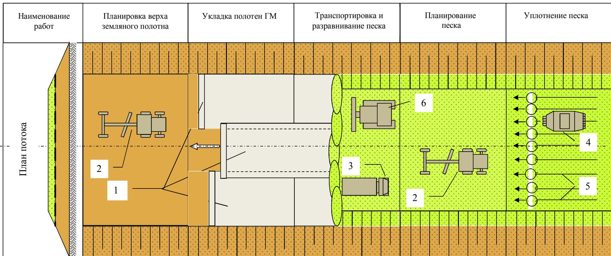
Рис. 1. Технологическая схема по устройству защитных (фильтрующих и дополнительно – дренирующих) прослоек из геоматериала «ГЕОТЕКС» под песчаным подстилающим слоем дорожной одежды: 1 – ГМ; 2 – автогрейдер; 3 – автомобиль-самосвал; 4 – каток на пневмошинах; 5 – последовательность проходов катка; 6 – бульдозер.
