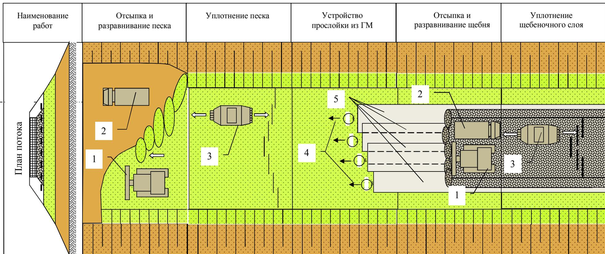
Рис. 2. Технологическая схема по устройству разделяющих прослоек из геоматериала «ГЕОТЕКС» под основанием дорожной одежды:
