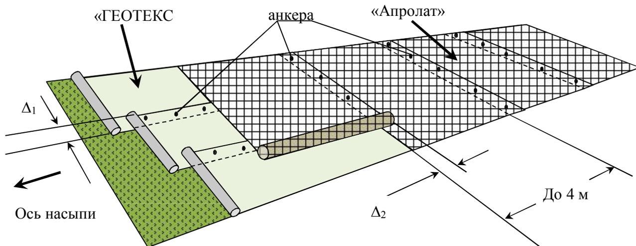
Рис. 4. Схема укладки геоматериала «ГЕОТЕКС» при строительстве на слабом основании (а) в том числе в сочетании с более жестким армирующим материалом – георешеткой «АПРОЛАТ» (б).
