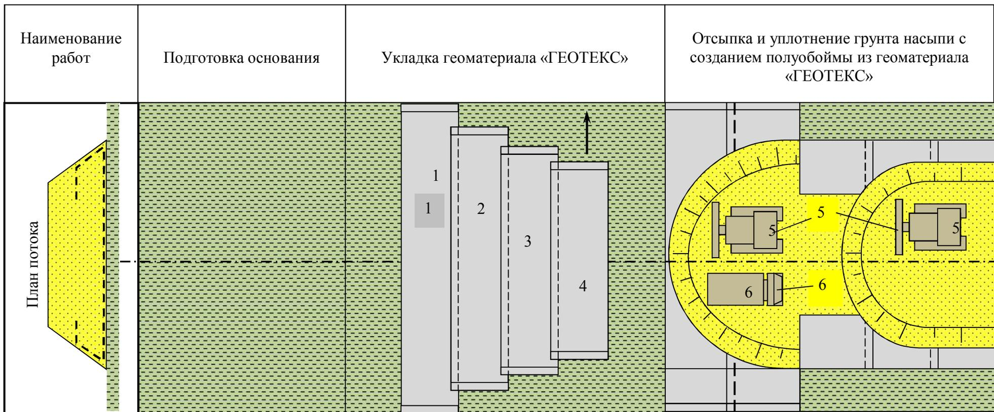
Рис. 3. Технологическая схема по устройству разделяющих и армирующих прослоек из геоматериала «ГЕОТЕКС» на слабом основании: 1-4 – ГМ; 5 – бульдозер; 6 – автомобиль-самосвал.
